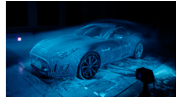
Bild: Verschmutzungsuntersuchung im Thermowindkanal ©FKFS
